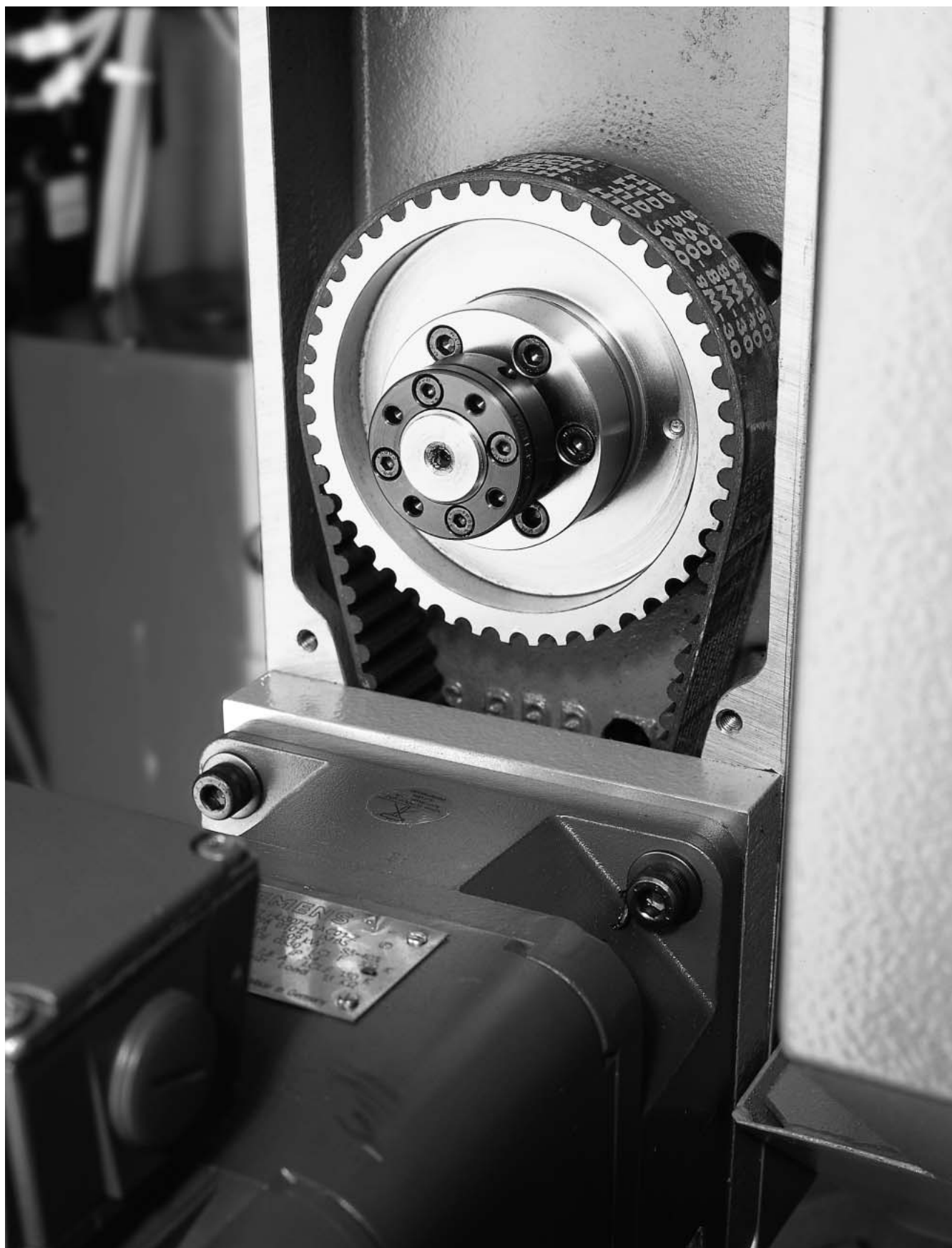
CONTI SYNCHROBELT® HTD Zahnriemen in einer Werkzeugmaschine
